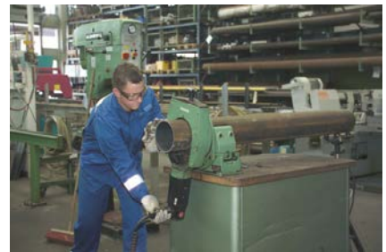
Zuschneiden eines Rohres nach Maß
