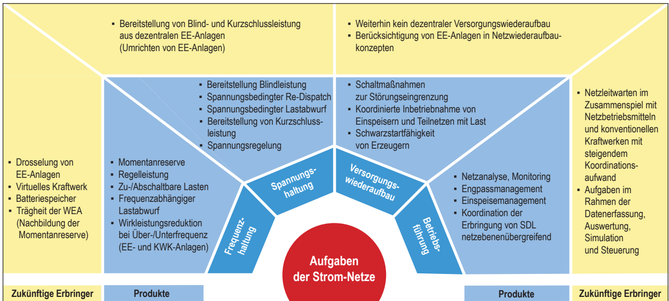
Abb. 6: Aufgaben der Strom-Netze bei dezentraler Energieversorgung
