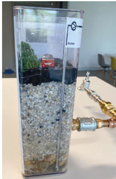
Ansicht des Brunnens im DVGW-Experimentierset „Grund für Wasser“
